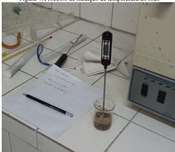
Figura 4. Processo de medição de temperatura do lodo
